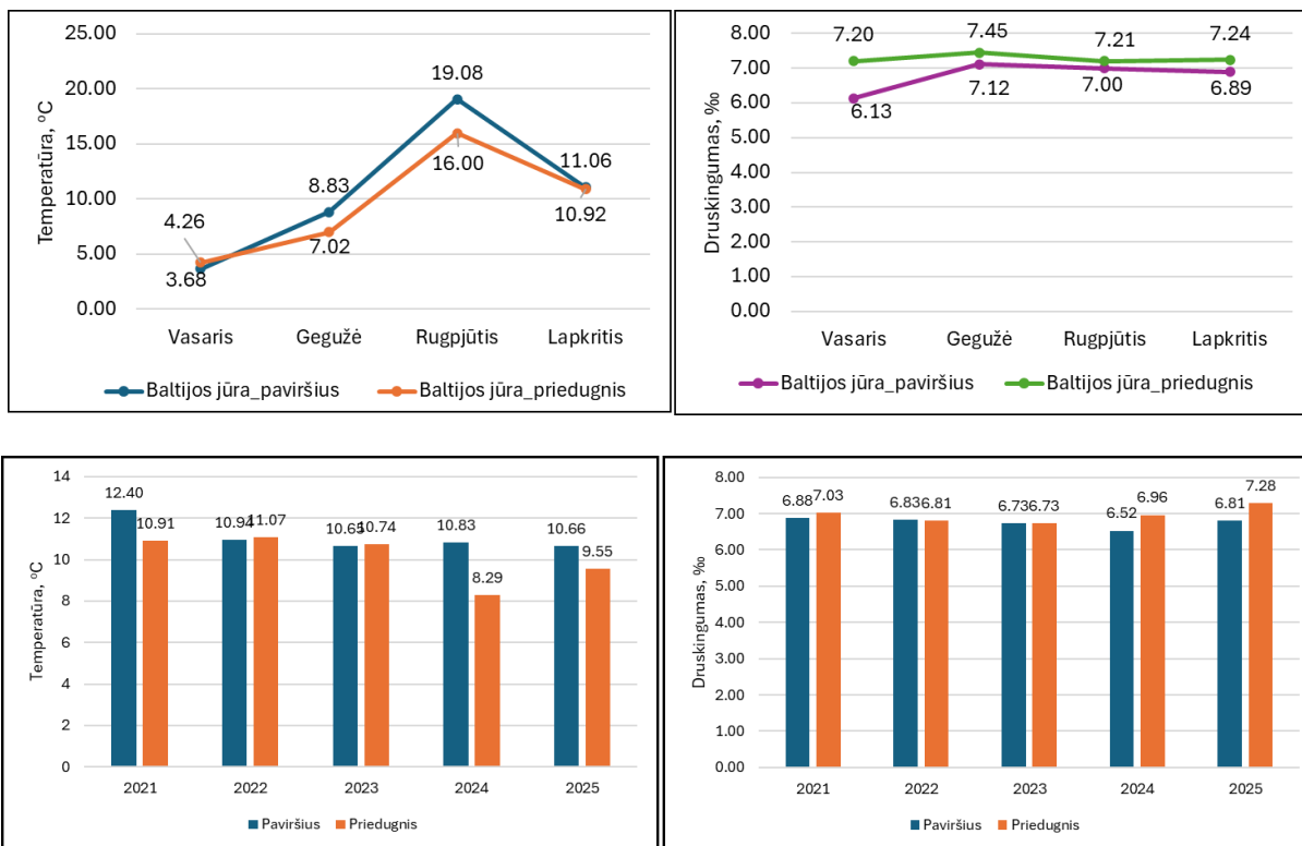
2.3.1 pav. Baltijos jūros vandens vidutinės temperatūros ir druskingumo sezoninis pasiskirstymas paviršiaus ir priedugnio sluoksnyje bei metiniai vidurkiai 2021–2025 m.
