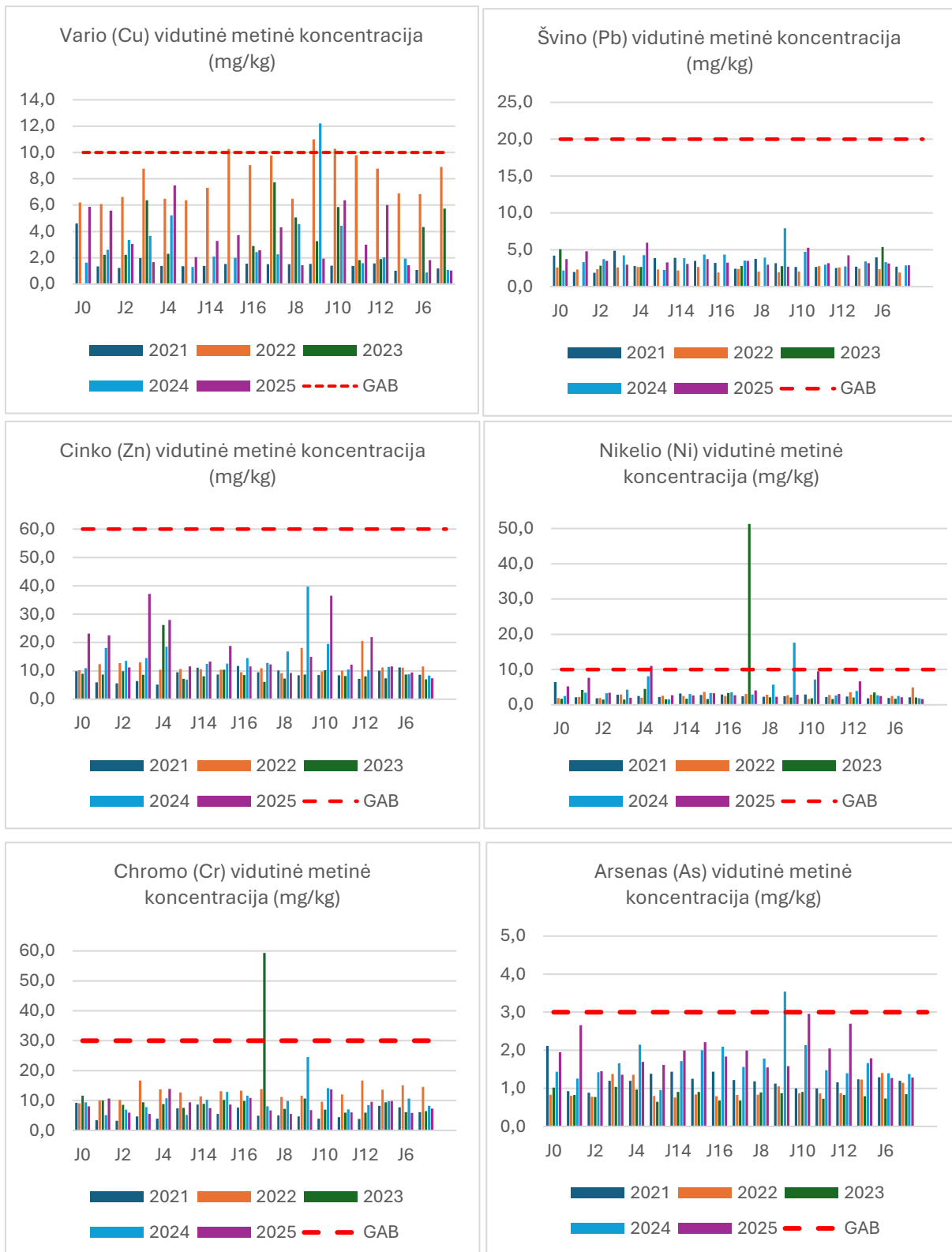
3.1.3 pav. Vidutinė metinė Cu, Pb, Zn, Ni, Cr ir As koncentracija Baltijos jūros dugno nuosėdose 2021–2025 m. laikotarpiu.
